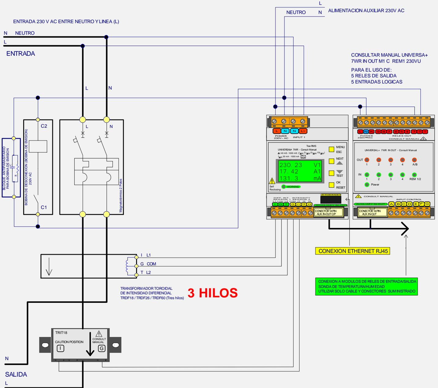
CONSULTAR MANUAL UNIVERSA+ 7WR IN OUT M1 C REM1 230VU PARA EL USO DE: 5 RELES DE SALIDA 5 ENTRADAS LOGICAS
