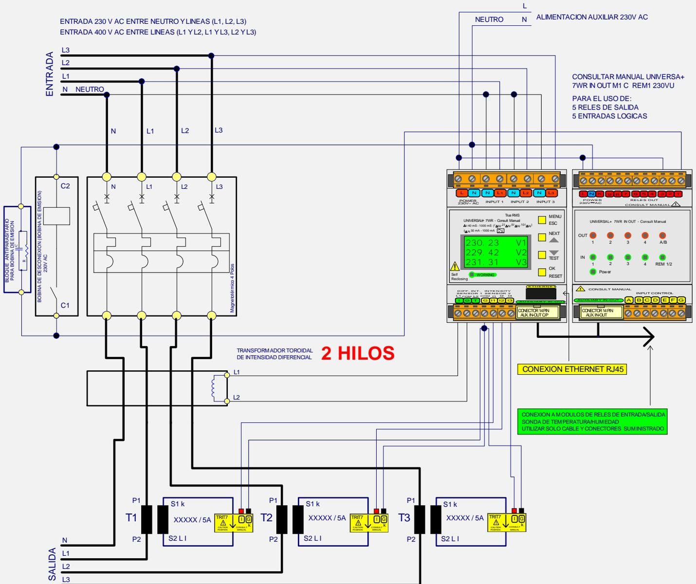
TRANSFORMADOR TOROIDAL DE INTENSIDAD DIFERENCIAL 2 HILOS
