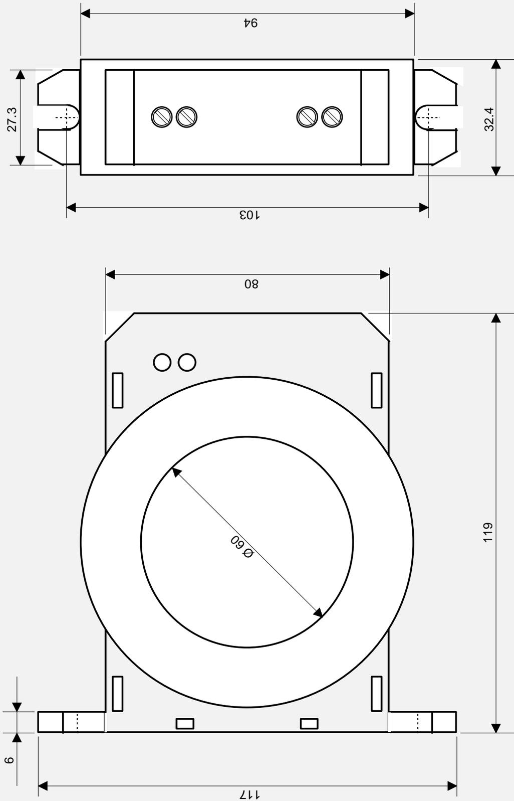
DIMENSIONES TRANSFORMADOR TOROIDAL: TRDF60
