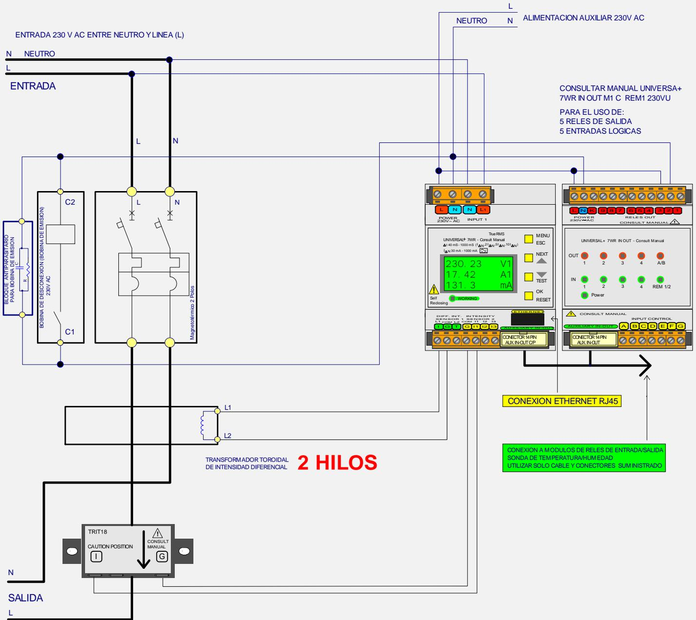
TRANSFORMADOR TOROIDAL DE INTENSIDAD DIFERENCIAL 2 HILOS PASAR LOS CONDUCTORES FASE (L) Y NEUTRO (N) POR EL ORIFICIO DEL TRANSFORMADOR TOROIDAL INDIVIDUALMENTE EMPAREJADO Y AJUSTADO PARA SU MODULO NO INTERCAMBIAR
