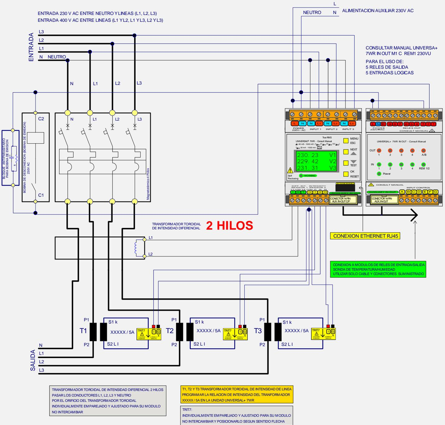
TRANSFORMADOR TOROIDAL DE INTENSIDAD DIFERENCIAL 2 HILOS
