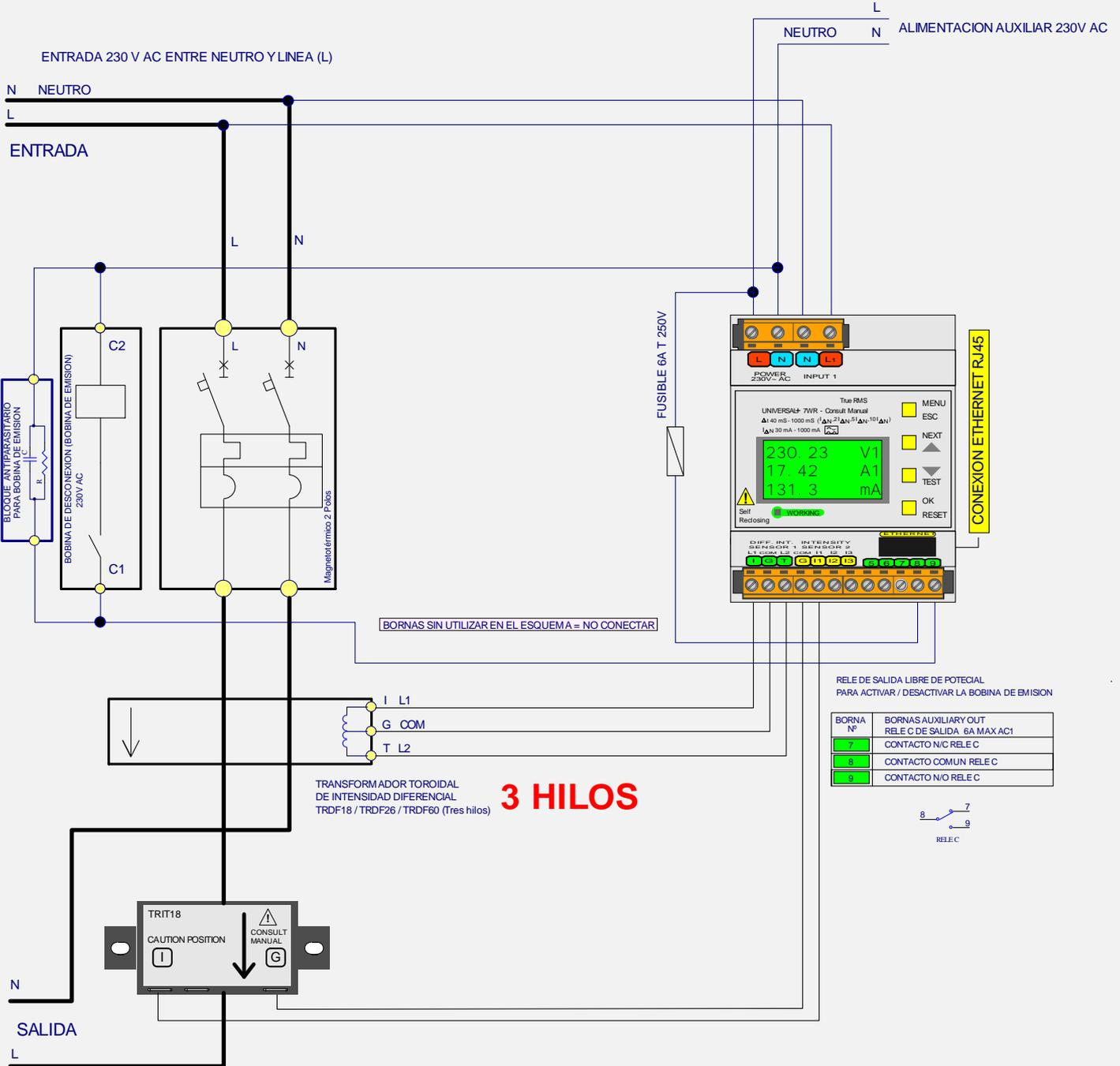
BORNAS SIN UTILIZAR EN EL ESQUEMA = NO CONECTAR
